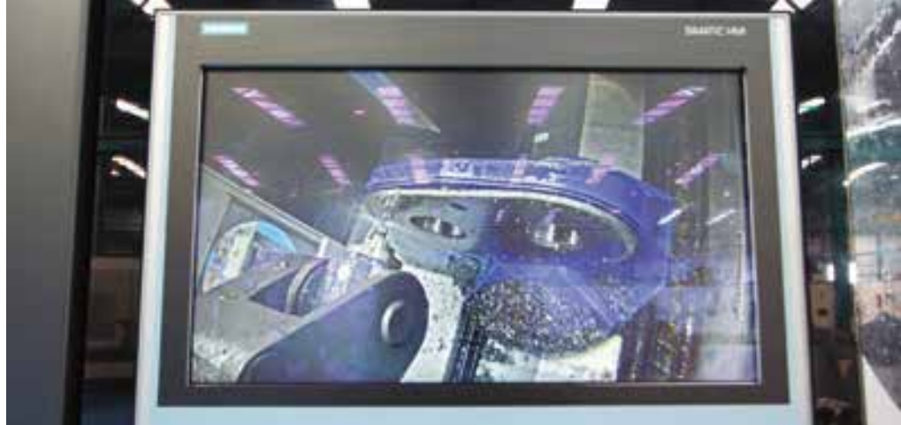
Pantalla para control del proceso de mecanizado, en el modelo THC16 Multiprocess.
