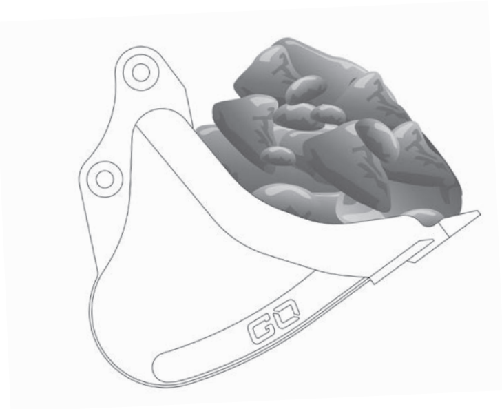
Acoplamiento directo a bulones (sin enganche)
