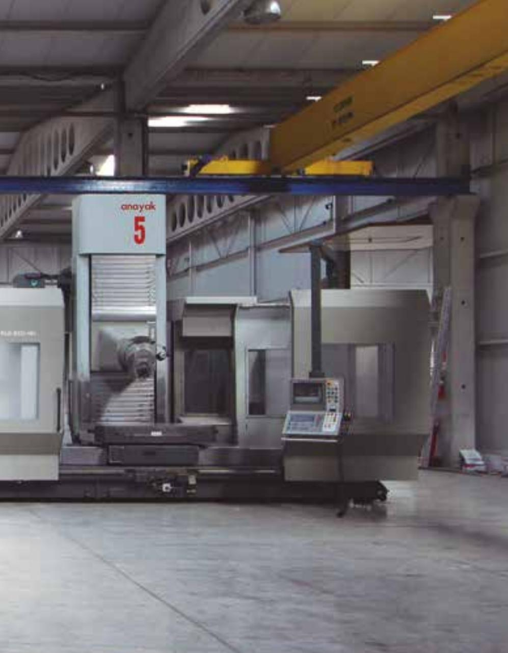
4.000 mm. Además, gracias a su configuración en “T” puede contar con cursos transversales de hasta 2.500 mm. Ofrece una excelente versatilidad acompañada de unas altas prestaciones dinámicas. Su cabezal automático y su mesa
