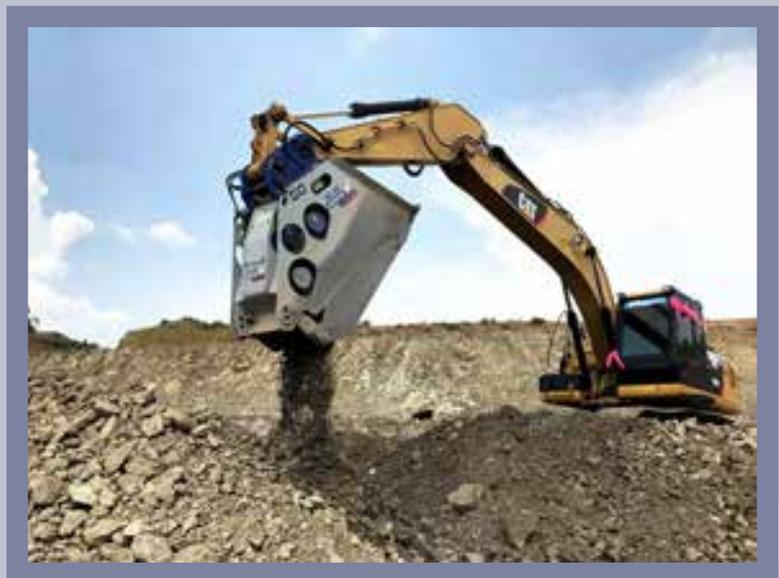
XC20 triturando roca con una salida máxima de 150 mm.
