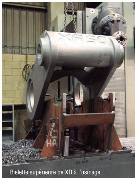
Biolette supérieure de XR à l'usinage.
