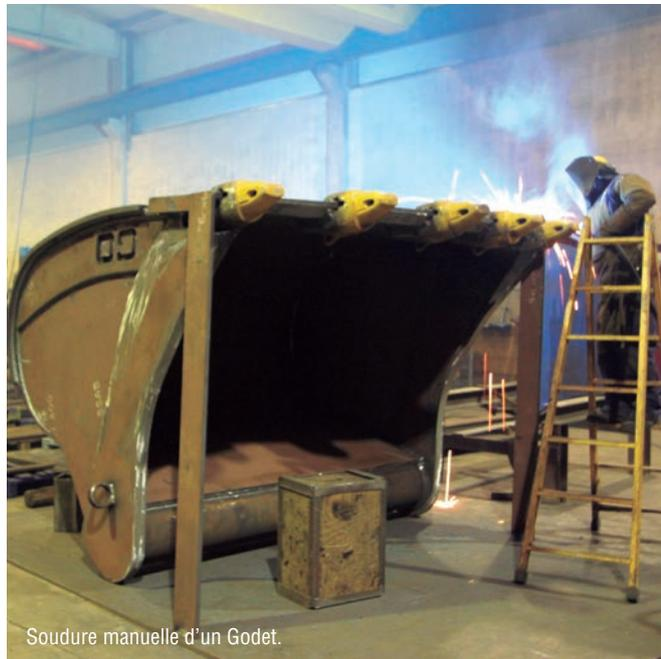
Soudure manuelle d'un Godet.
