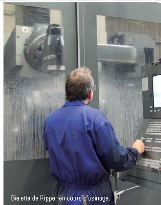
Bielle de Ripper en cours d'usinage.
