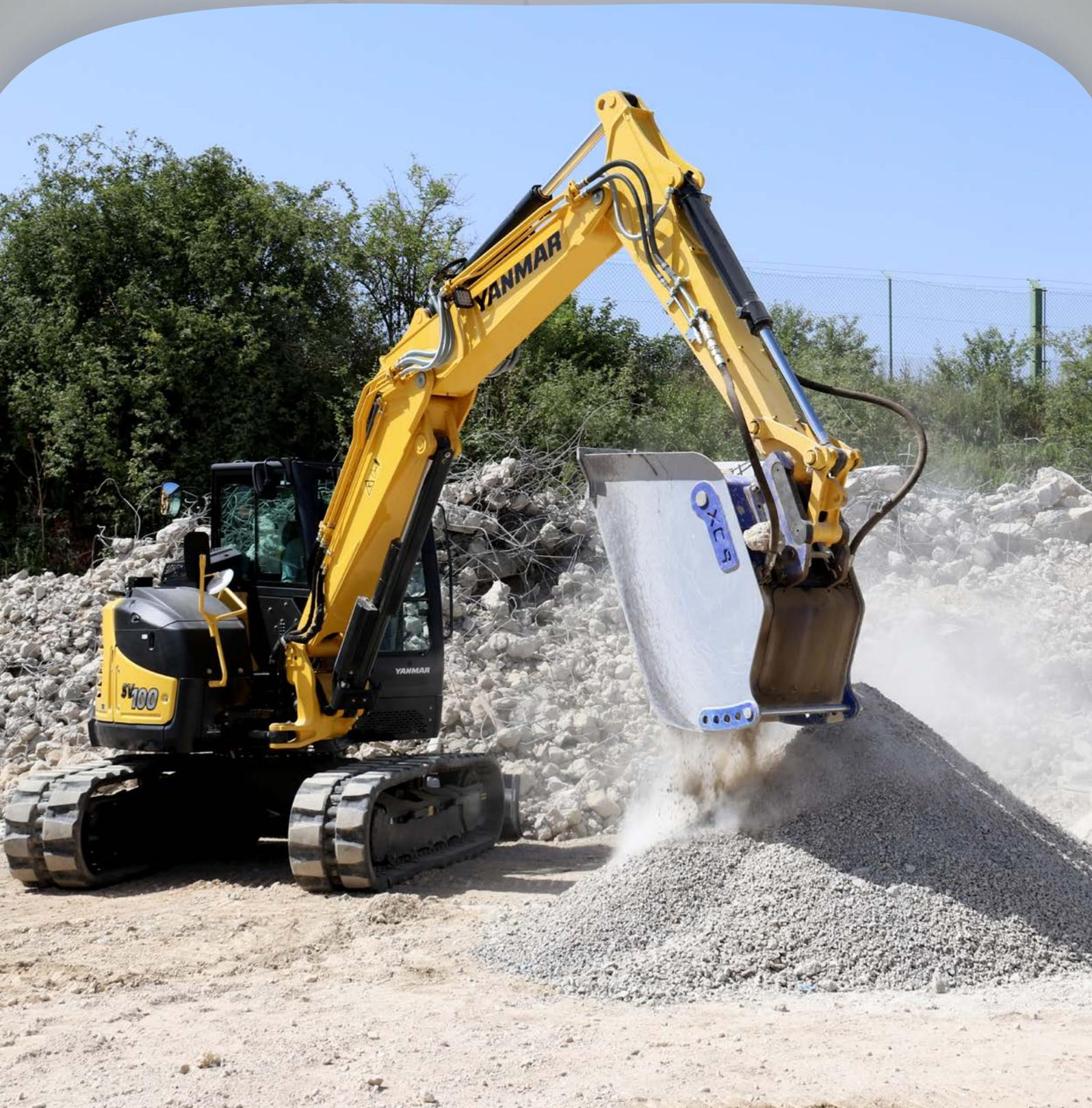
■■■ Primer prototipo del modelo XC9, de la nueva serie de cazos machacadores Xcentric Crusher
