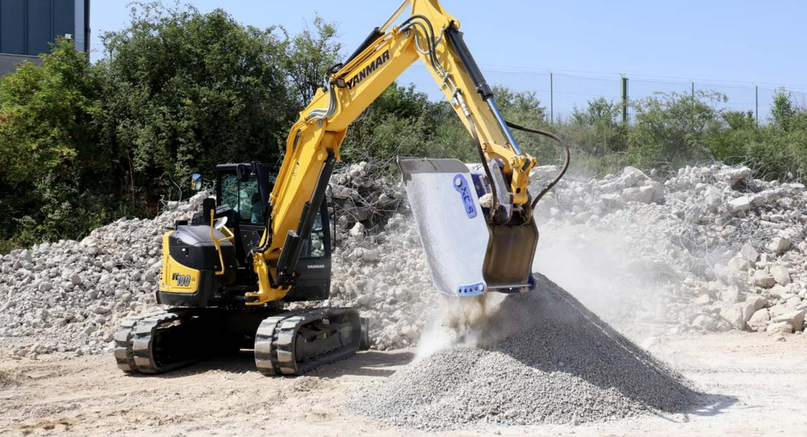
Primeras pruebas realizadas con el Xcentric Crusher XC9
