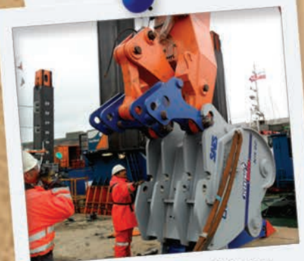
Xcentric Ripper XR80 para trabajos bajo el agua, con sombrero y enganche especial (2013)
