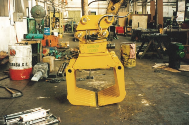
Pinza y enganche fabricados por Grado Cero en su segundo taller.
